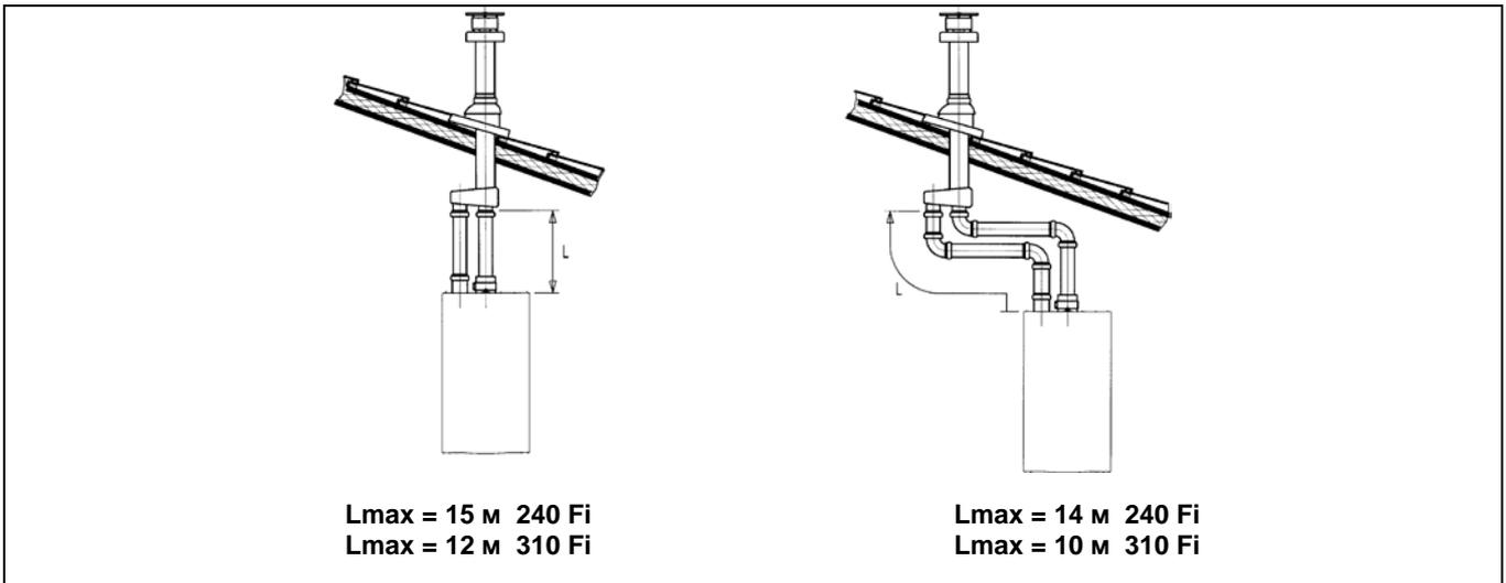
**Обратите внимание!** При установке дымохода убедитесь, что труба хорошо изолирована (напр., стекловолокном) в месте прохода трубы сквозь стену здания. Подробные инструкции об установке труб смотри в руководствах, прилагаемых к комплектам.
