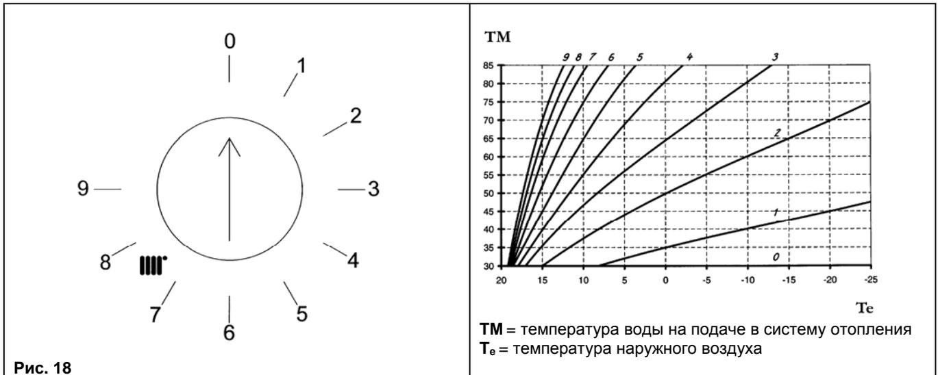
**Внимание:** Значение температуры на подаче ТМ зависит от положения переключки или переключателя T.RISC. на электронной плате (см. главу 11). Таким образом, максимальная установленная температура может быть 85 или 45°C.
