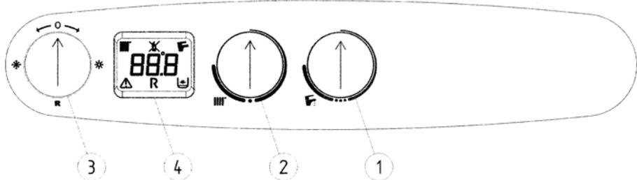
**Внимание!** При первом розжиге горелка может загораться не сразу (пока не выйдет воздух из газовых труб), вызывая "блокировку" котла. В этом случае мы рекомендуем повторять процедуру зажигания, пока газ не дойдет до горелки. Для сброса блокировки переключатель режимов на 2 сек перевести в положение (R).
